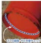
底部の腐食
